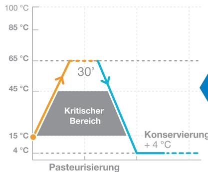
Mit dem automatischen **Selbstopasteurisierungssystem (optional nur für XVL 1 und XVL 3)** können Sie selbst entscheiden wann Sie die Maschine reinigen. das Intervall sollte max. 42 Tagen betragen. Als zusätzliche Garantie für die hygienische Sicherheit geht die Maschine automatisch in den Stillstand, wenn der Bediener am Ende der festgelegten Tage nicht die vollständige Reinigung durchführt.
